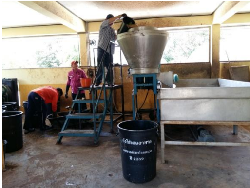
รูปที่ 7.1 การบดเศษอาหารจากครัวเรือนของเทศบาลตำบลโคกกรวดเพื่อนำไปหมักแบบไร้อากาศ
